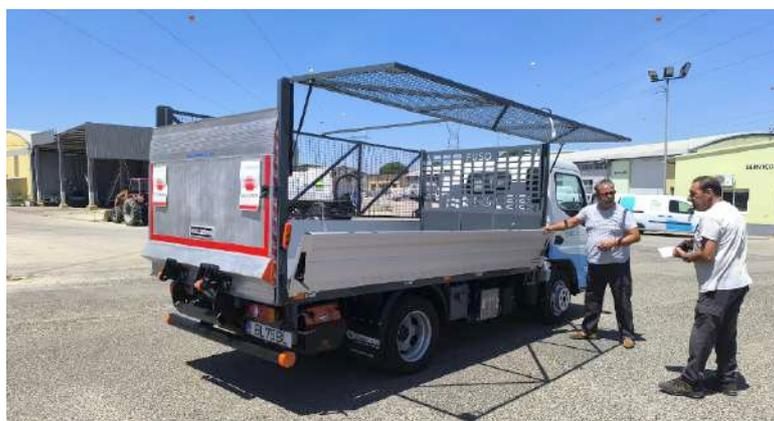
Figura 13 – Veículo para Recolha de Monos com Elevador Incorporado
